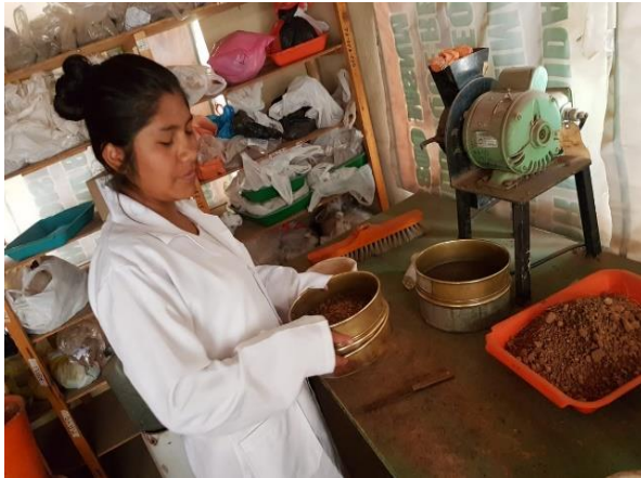
Foto 11. Tamizado de la muestra de suelo
