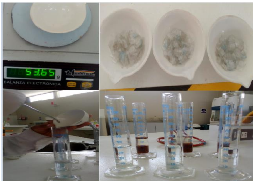
Anexo 8. Procedimiento para el desarrollo de Densidad (g/ml) para Aserrín (g).
