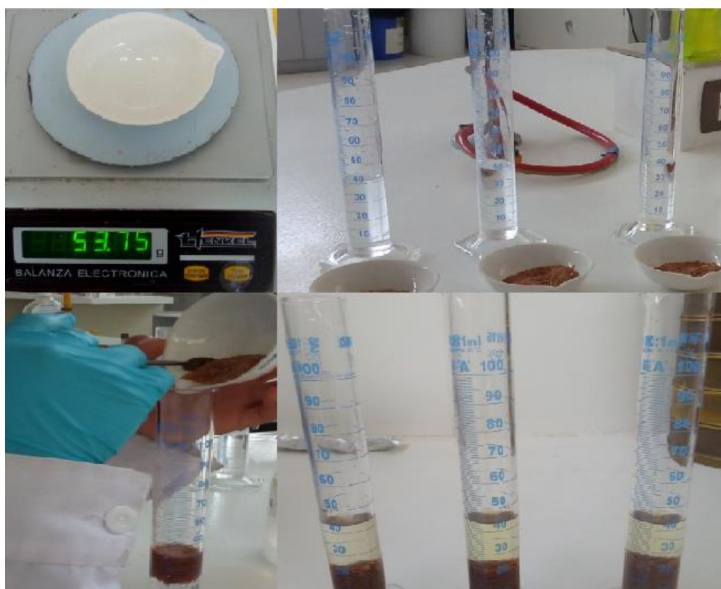
Anexo 8. Procedimiento para el desarrollo de Densidad (g/ml) para Aserrín (g).
