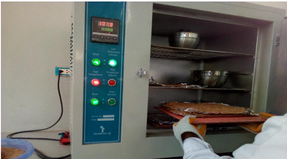
Anexo 3. Secado de aserrín de madera por capas en una estufa a 105°C
