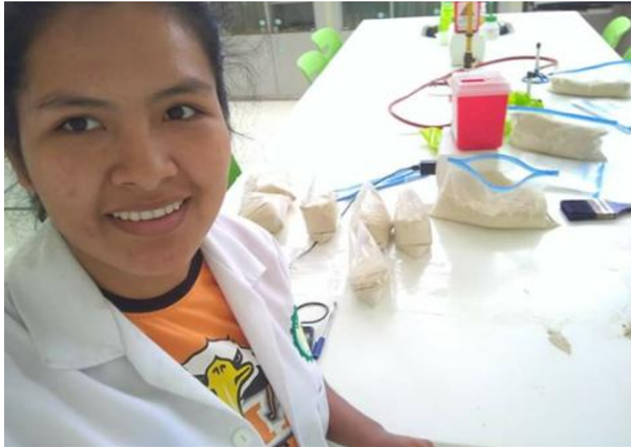
Almacenado de la molienda de coronta de maíz en bolsas ziploc para su posterior carbonización y activación
