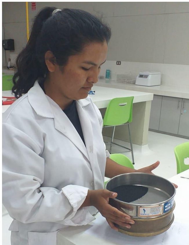
Tamizaje del carbón activo deshidratado para homogenizar el tamaño de partícula
