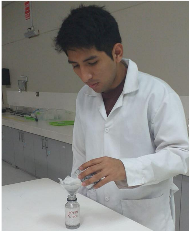
Filtración posterior a las pruebas de remoción
