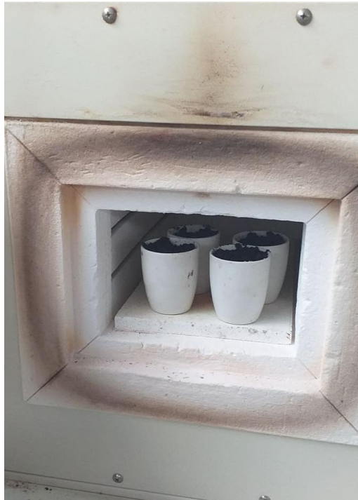
Pirolización de la biomasa activada de coronta de maíz durante 30 minutos
