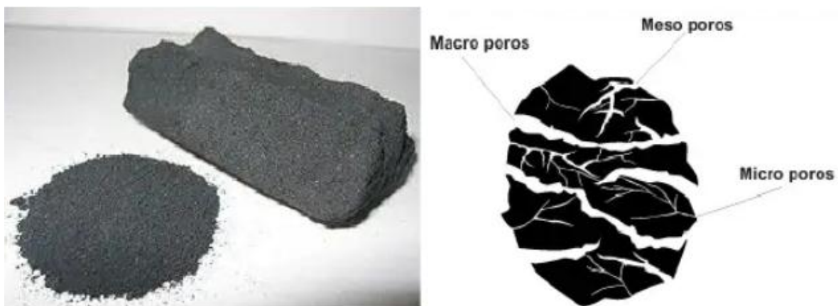
Figura 5. Carbón activo y su estructura porosa (García, 2013)
