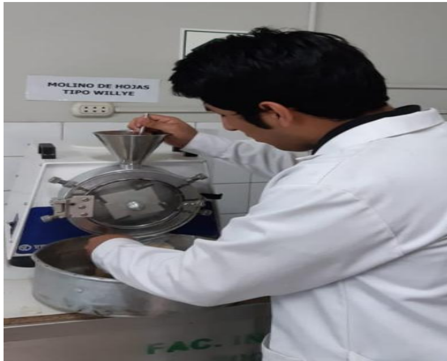
Trituración de la coronta de maiz mediante molino de hojas
