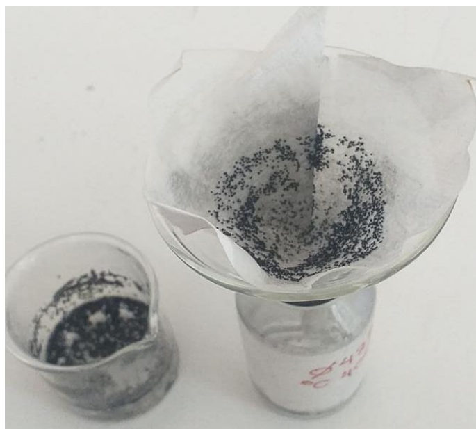
Filtrado del carbón activo de las pruebas de adsorción
