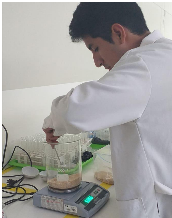
Pesaje de la molienda de coronta de maíz para la activación con el ácido fosfórico
