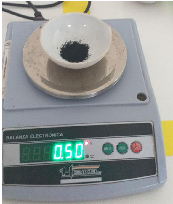
Pesaje del carbón activo deshidratado para el ensayo de adsorción
