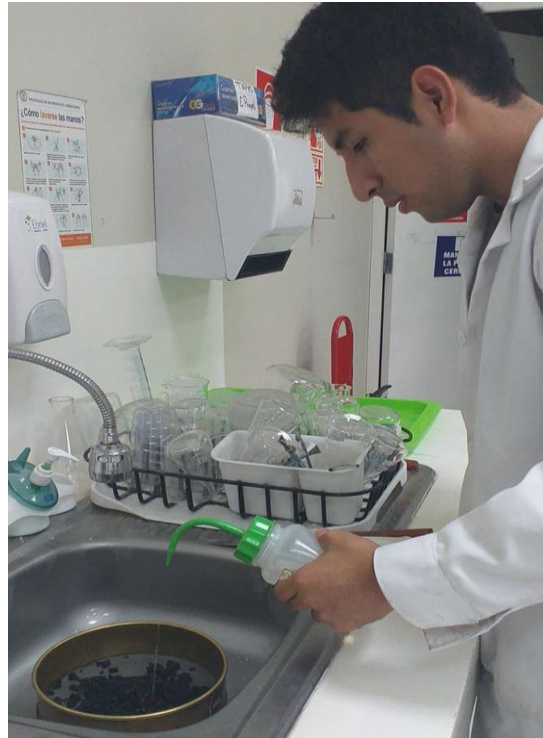
Lavado del carbón activo para el incremento de pH
