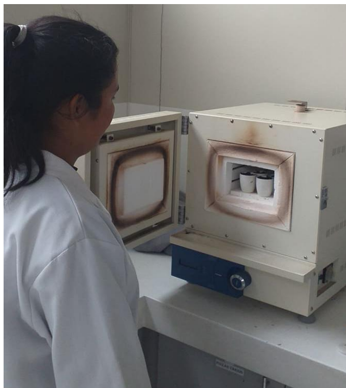
Pirolización de la biomasa a 300, 400 y 500 °C
