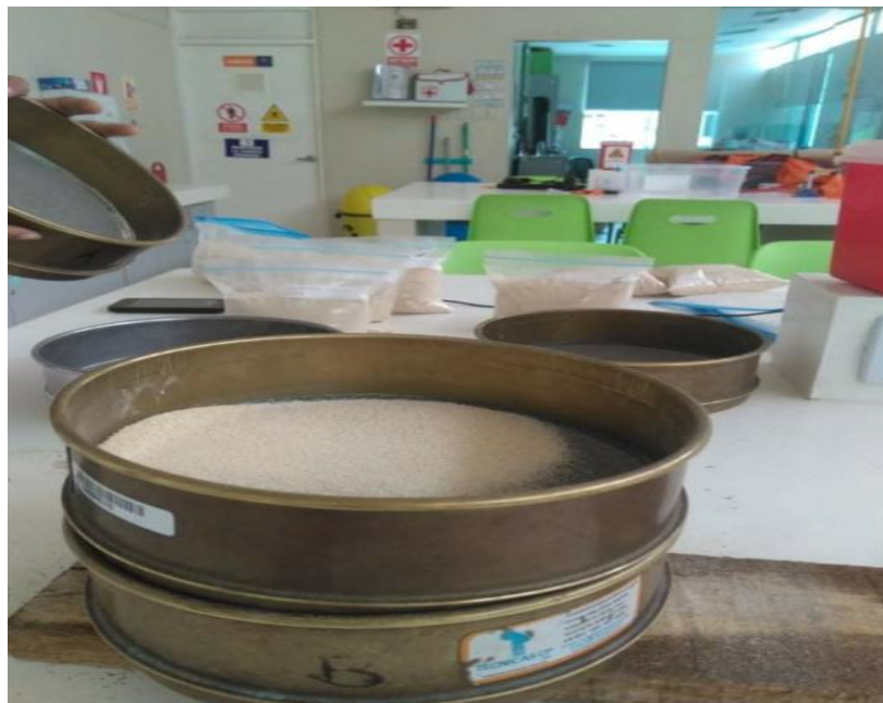
Tamizado a diámetro de 425 micras de la molienda de coronta
