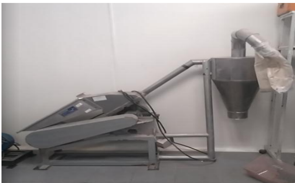
Trituración de la coronta mediante molino de martillo
