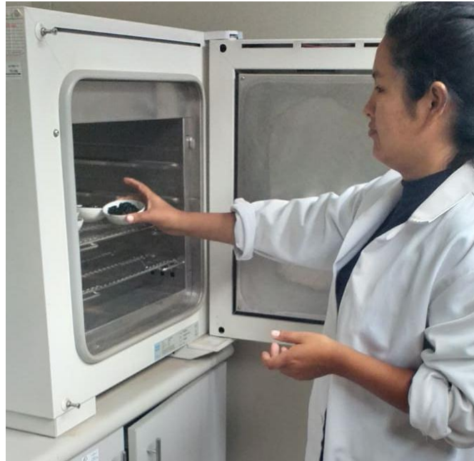
Deshidratación del carbón activo a 80°C durante 12 horas
