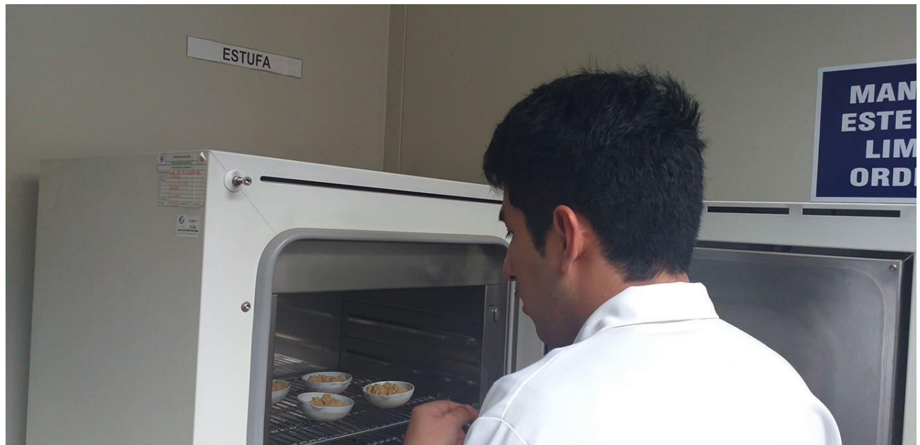
Deshidratación de la biomasa para su secado a 80°C por 12 horas
