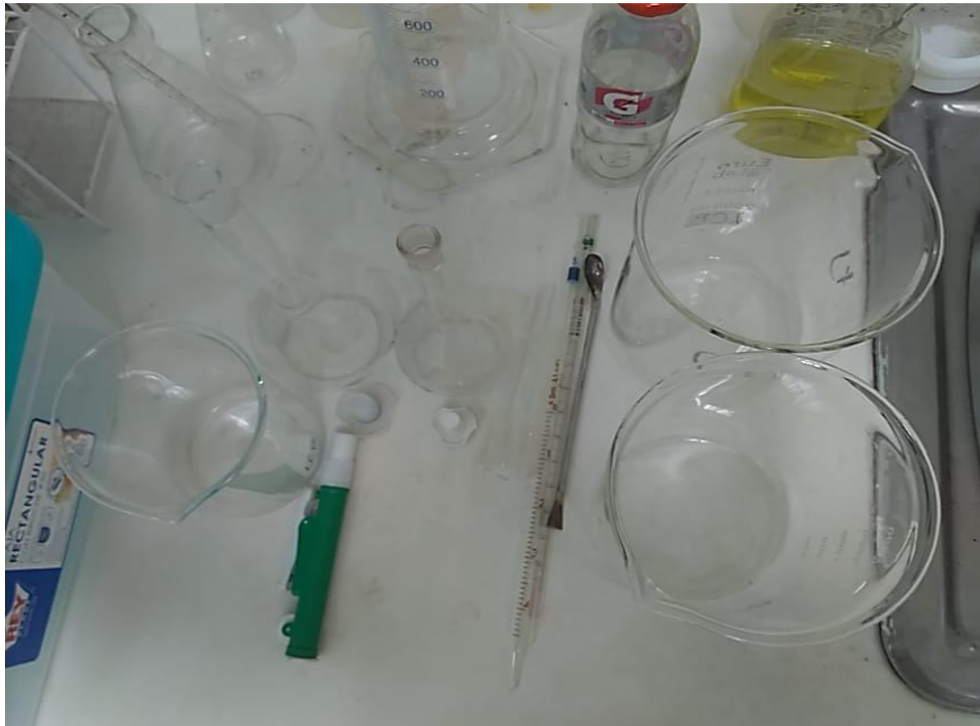
Materiales lavados a 1M con ácido nítrico para las pruebas de adsorción
