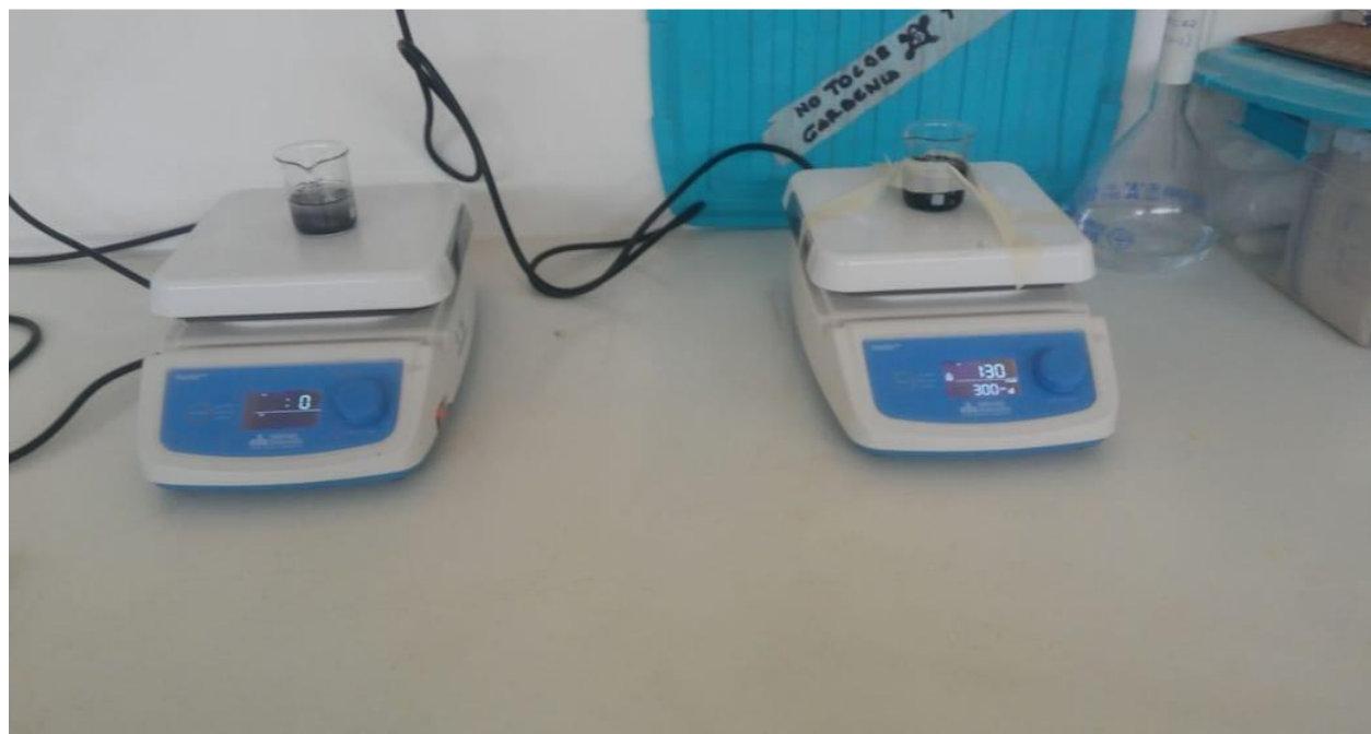
Pruebas de adsorción a 250 rpm durante 2 horas
