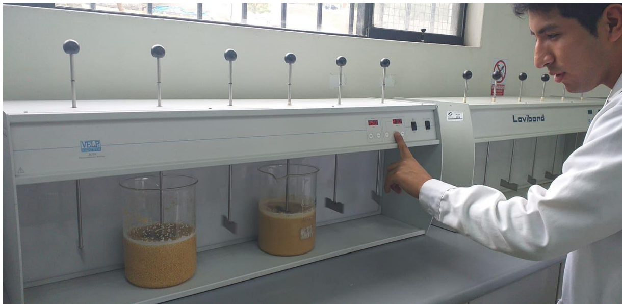
Activación de la coronta de maíz durante 4:30 h en la prueba de jarras
