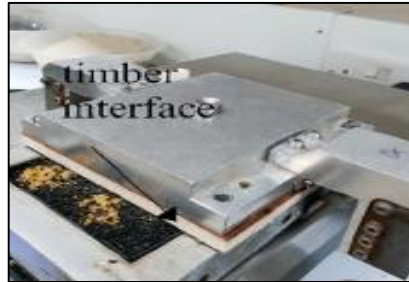
Figure 3. Ensayo del corte directo con una interfaz de madera (Tsiavos et al., 2019)
