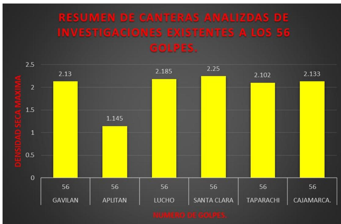
Se asume que a los 56 golpes ya se obtiene la densidad adecuada por el comportamiento de la curva esto según la norma ASTM 1557, donde se realizaron diferentes muestras y se determinó que 56 número de golpes es suficiente para determinar la máxima densidad seca, sin embargo, analizando vemos que para los suelos granulares del Perú debemos aplicar una mayor compactación, datos correctos que posteriormente serán llevados a campo.
