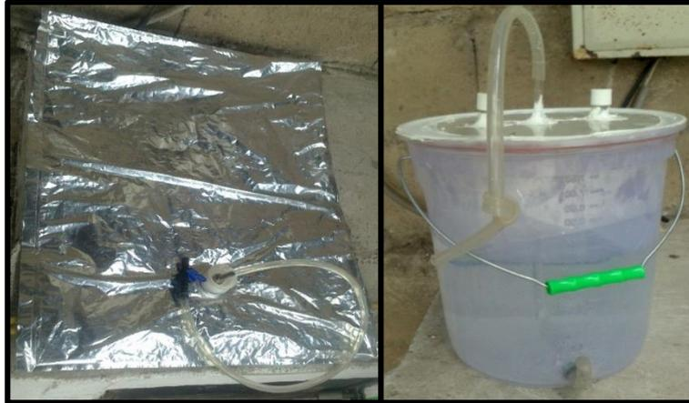
Figura 16 y 17 – Bolsa de aluminio y adaptación de tanque Mariotte
