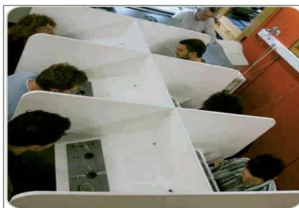
**Figura 3 - Panel de expertos – Determinación de La Concentración de olor por Olfatometría (Torres et al., 2008)**
