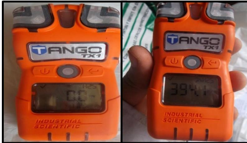
**Figura 19 y 20 - Detector monogas Tango TX1 – Doble sensor – Rango óptimo De detección de 0 – 200 ppm**
