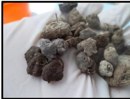
**Figura 32 – Capa biológica desarrollada sobre medio Filtrante (distinguida por la coloración)**
