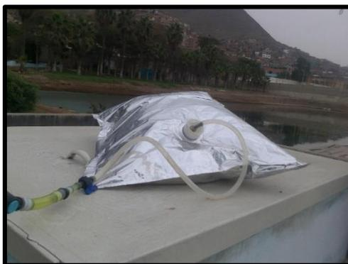
**Figura 42 – Bolsa de aluminio siendo llenada de biogás**
