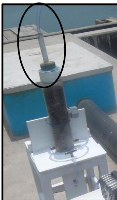
**Figura 61 – Punto de monitoreo – efluente del biofiltro**
