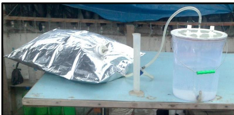
**Figura 43 – Bolsa de aluminio conectada al tanque Mariotte**
