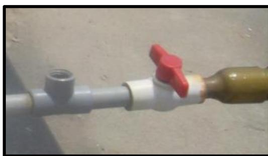
Figura 23 – Válvula de control y punto de captación de oxígeno atmosférico
