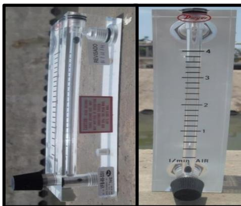
Figura 25 y 26 – Rotámetro, control de caudal de ingreso (biogás)
