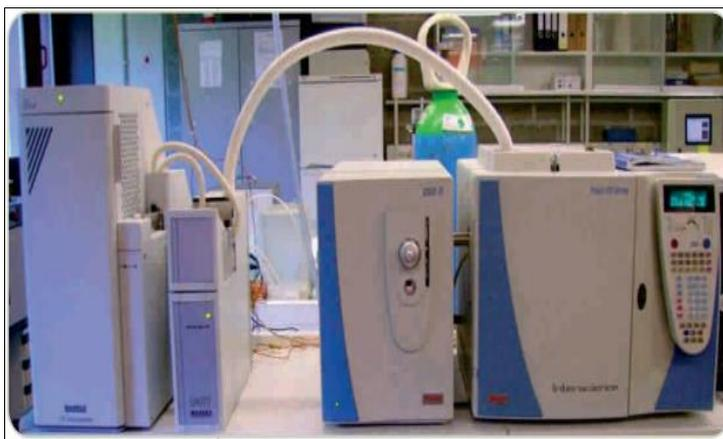
**Figura 2 – Cromatografía de gases y espectrómetro de Masas (GC – MS) acoplado a un equipo de Desorción térmica (Torres et al., 2008)**
