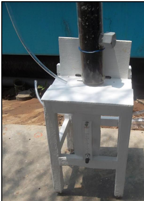
Figura 55 – Biofiltro instalado (válvulas, rotámetro, soporte del biofiltro).
