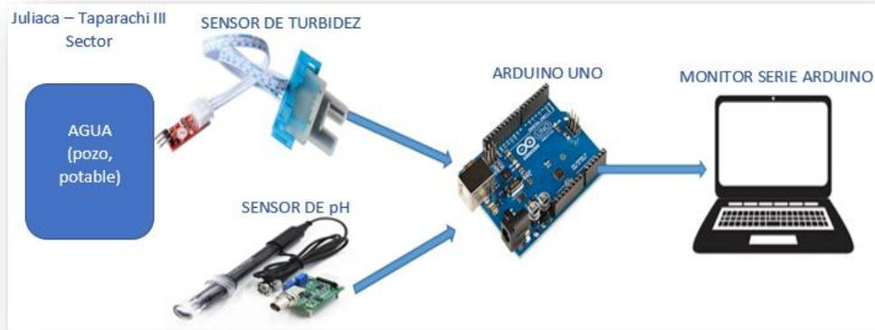
Figura 1: Arquitectura de conexión
