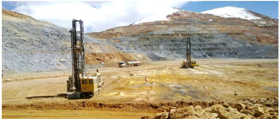
*Figura 11.* Perforación de taladros, colocación de agentes detonadores.
